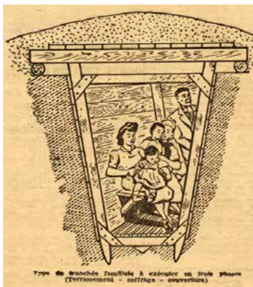
Fig. 13 - Plusieurs élèves, dont Michel Swaenepoël de Coupvray, évoquent dans leurs copies les tranchées creusées dans les jardins pour se protéger des bombardements. La Défense passive, dans une fiche datée de 1944 intitulée « Construisez vous-même votre tranchée familiale », en fournit un modèle (AD77, SC21384)
