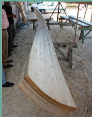
FABRICATION DE LA FLÈCHE EN ATELIER : LES LAMES DE BOIS SONT COLLÉES SUR UN GABARIT ; UN ARÊTIER ACHÉVÉ.
